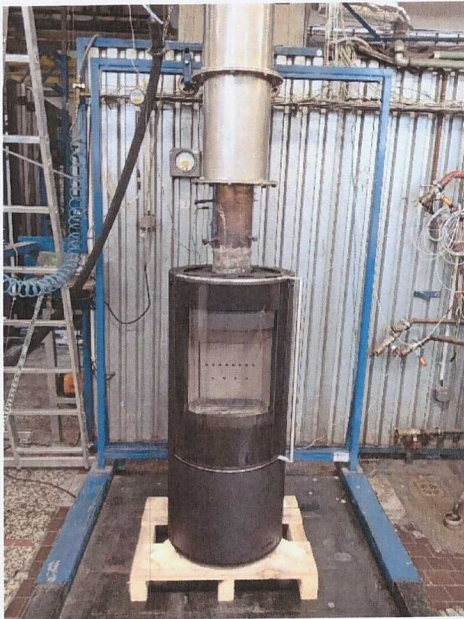
Bild der Installation des Geräts für alle Tests
