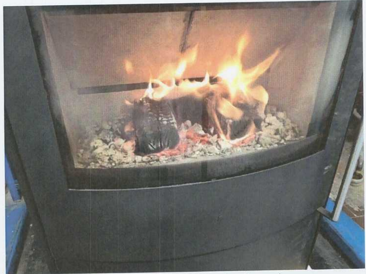
Bild der Brennstoffcharge in der Brennkammer
